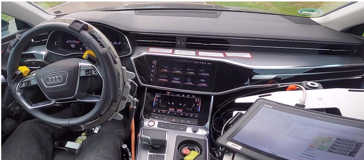
Abbildung 1: Fahrzeug (Audi) mit Staehle-Fahrroboter und iMAR Lokalisierungssystem, eingebunden in iSWACO-ARGUS Leitstand mit iARGUS-CMD Leitstandssoftware
