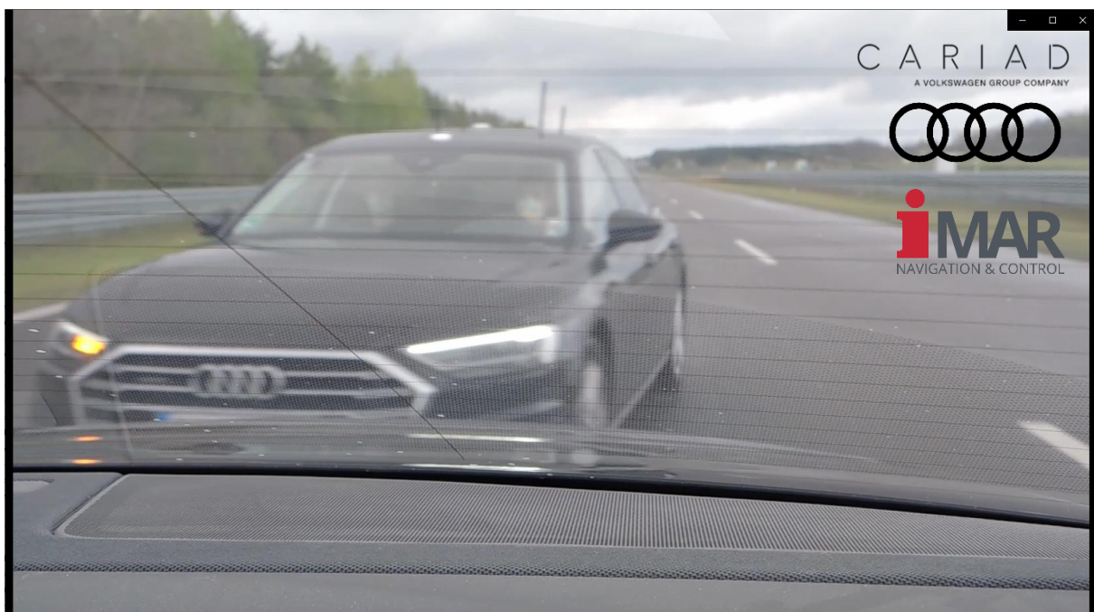
Abbildung 9: Szenariobasierte Prüfung der automatisierten Fahrfunktion des VUT - Aktion des TSV in Abhängigkeit des Überholversuchs des VUT
