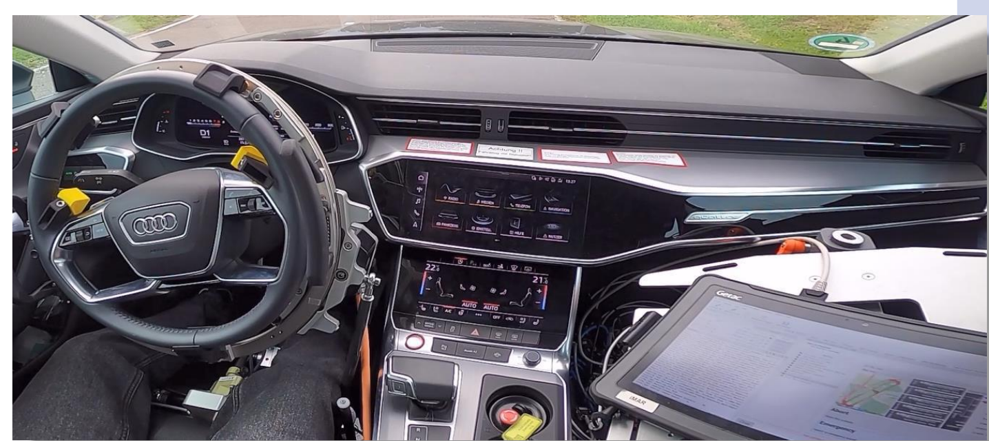
TSV (Audi) mit Staehle-Fahrroboter und iMAR Lokalisierungssystem, eingebunden in iSWACO-ARGUS Leitstand mit iARGUS-CMD Leitstandssoftware
