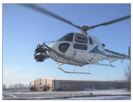
Industrielle Anwendungen sind die Stabilisierung von Kameras auf Helikoptern z.B. bei der Produktion von IMAX-Filmen, die Stabilisierung von Sensorplattformen auf Forschungsflugzeugen und Luftschiffen oder die Navigation unbemannter Unterwasserfahrzeuge (AUV).
