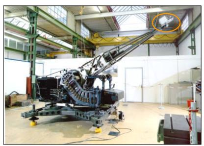
werken (SF) in Emmen und bei Westland Helicopters zur schnellen und präzisen Ausrichtung verwendet wird (Foto). Mit zwei iPegasus-Systemen im Differenzbetrieb ist es sogar möglich. die Ausrichtung von Waffensystemen auf Marineschiffen in Fahrt zu kalibrieren, iPE-GASUS arbeitet wie eine 3D-Wasserwaage und erlaubt die Ausrichtung mit Genauigkeiten von wenigen tausendstel Grad in allen drei Achsen. Ferner wird
