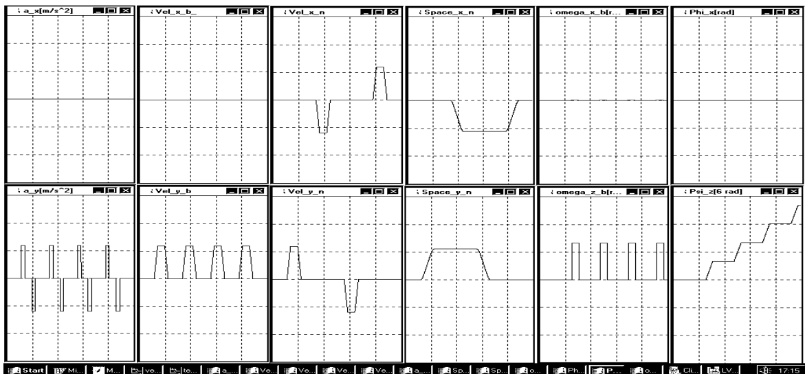
Abb. 3.1 Simulierte rechteckige Trajektorie der Translations- plus Rotationsbewegung (Runge-Kutta 5 Integrationsmethode)
